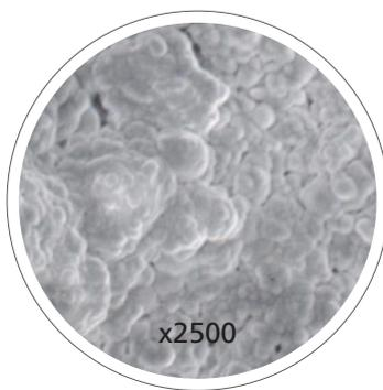
Этот образец неуплотненного бетона показывает пористую структуру бетона, которая приводит к износу и ухудшению качества.
